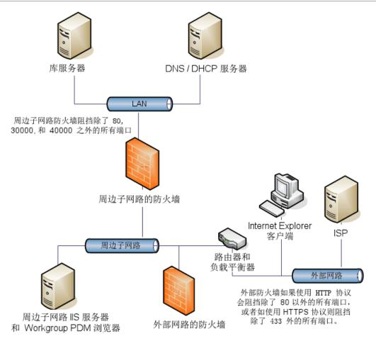
Internet Explorer 客户端通过 80 端口 (如果配置到使用 SSL 则为 443 端口 )连接到 Workgroup PDM Viewer/IIS 服务器。Workgroup PDM Viewer 然后可使用 30000 或 40000 端口连接到库服务器。库服务器将所需信息发回到 Workgroup PDM Viewer , 此然后将信息回馈到 Internet Explorer 客户端。
